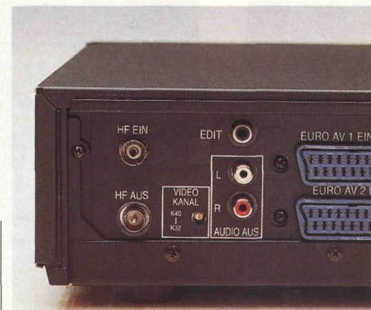
Auf der Kopftrommel der HiFi-Videorecorder sitzen vier Abtastköpfe für das Bild und zwei für den HiFi-Ton (links). Zur Audio/Video-Verbindung dienen die Scart- und Cinch-Anschlüsse (unten).
