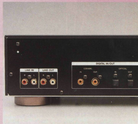
Für digitale Überspielungen ist der DTC-60 erfreulicherweise auch mit koaxialen Anschlüssen bestückt, die weniger störanfällig sind als die optischen.
