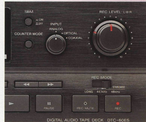
Ein unauffälliger Schalter ist äußerlich der einzige Hinweis auf das rauscharme Super Bit Mapping. Leider ist der Aussteuerungsregler als Doppelpotentiometer ausgeführt.
