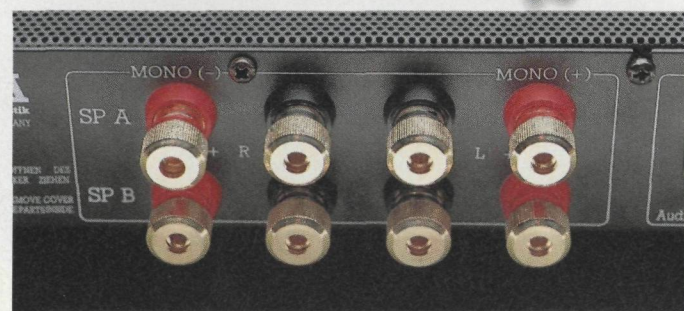
Prachtexemplar in schwarz-rot-gold: Bei Bedarf läßt sich die Endstufe in Monobrückenschaltung betreiben.
