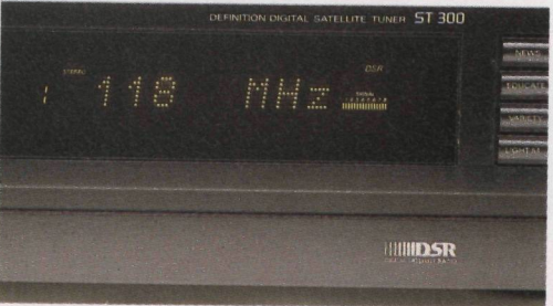
Hilfreich bei der Feinabstim- mung: Grundigs 16teiliger Leuchtbalken zeigt bei Mittenab- stimmung Vollausschlag
