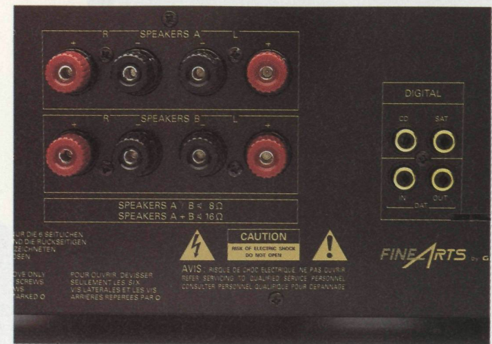
Bit für Bit zum DAT-Recorder: Drei digitale Quellen können zum Aufnahmeausgang durchgeschaltet werden
