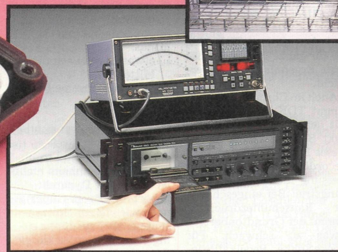
Frost und Hitze: Unser Klimaschrank simuliert Extremtemperaturen, wie sie im Auto auftreten. Die That's MG-X hat's nicht überlebt.
