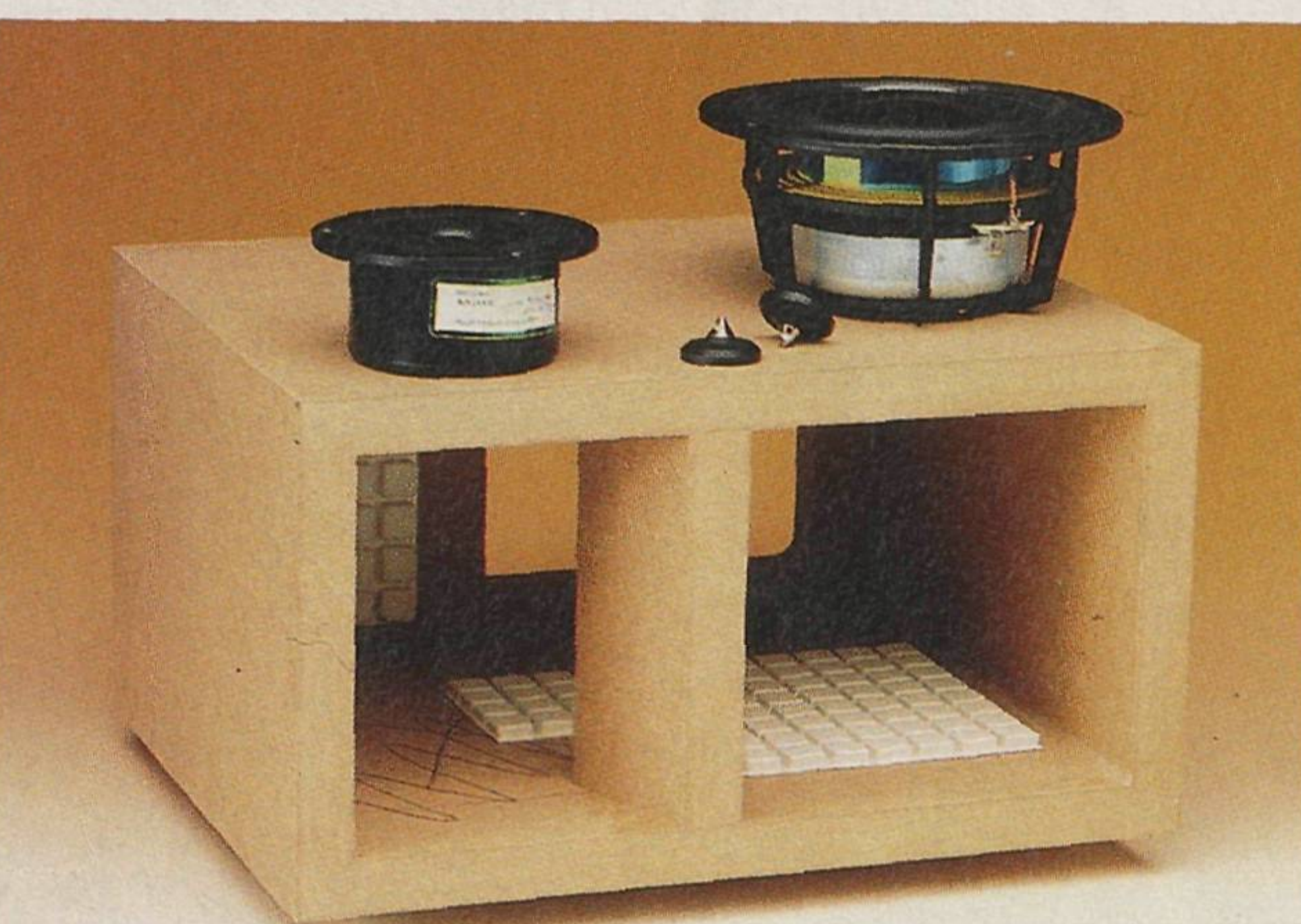
Die gewölbte Schallwand ermöglicht die Laufzeit-Kompensation zwischen den beiden Chassis. Das aus MDF-Platten gezimmerte Gehäuse ist zusätzlich mit stahlgelgefüllten Wabenkammern ruhig gestellt.
