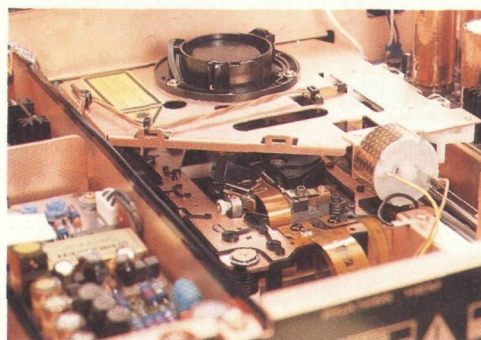
Mechanik vom Feinsten: Pioneer hat dem PD-93 Metallführungen für die präzise und sehr leise laufende Schublade sowie einen Linearmotor für den Laserantrieb spendiert.
