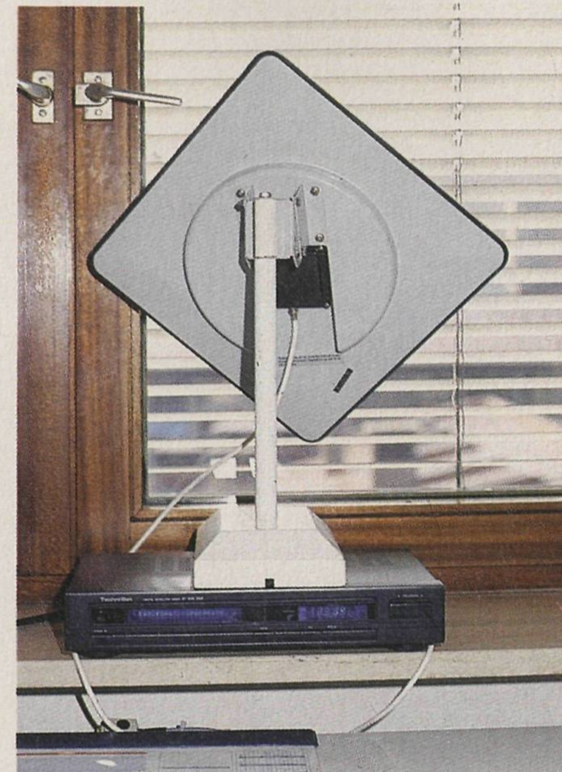
Eine kleine Flachantenne auf der Fensterbank, empfängt sogar hinter Isolierglas die Digital-signale.
