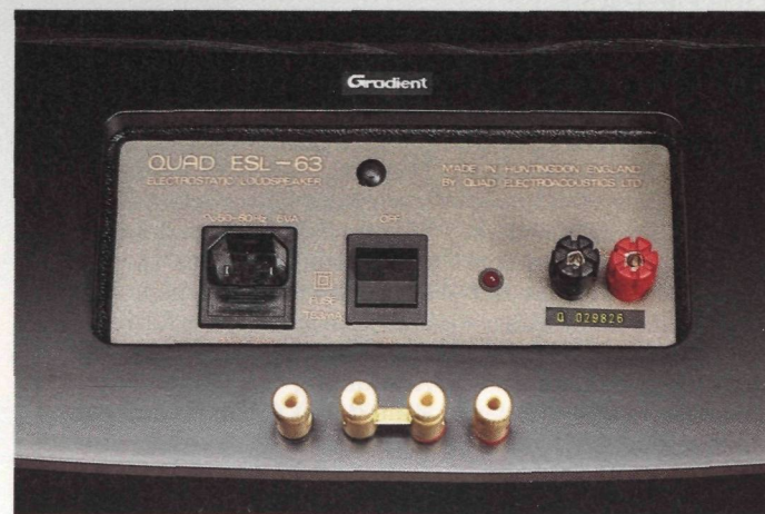
Für den Subwoofer SW-63 wird eine zusätzliche Endstufe benötigt. Diese wird an den vorderen Klemmen angeschlossen.
