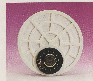
Durch die außermittige Anordnung des Schallwandlers wird mit dem HFI-100 räumliches Hören möglich.
