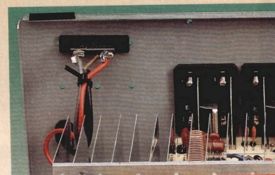
Im Yamaha-Vollverstärker ist die Netzsicherung gefährlich nah unter dem Gerätedeckel platziert. Ein Berühren der nicht isolierten Anschlüsse ist mit einem spitzen Gegenstand, durch die Kühlrippen hindurch möglich.
