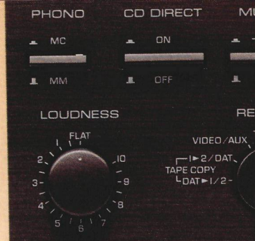
Die variable Loudness des Yamaha AX-730 ist bei jeder Lautstärke beliebig einstellbar.
