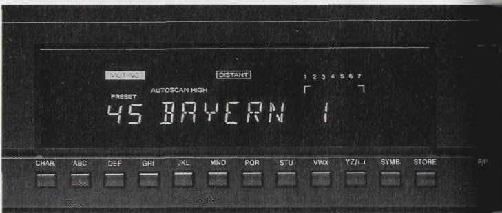
Speichergigant: 40 Senderstationen können beim Onkyo T-4650 abgespeichert werden. Programmname im Klartext: Nur der Philips FT 980 kann die Radiodaten entschlüsseln und anzeigen.
