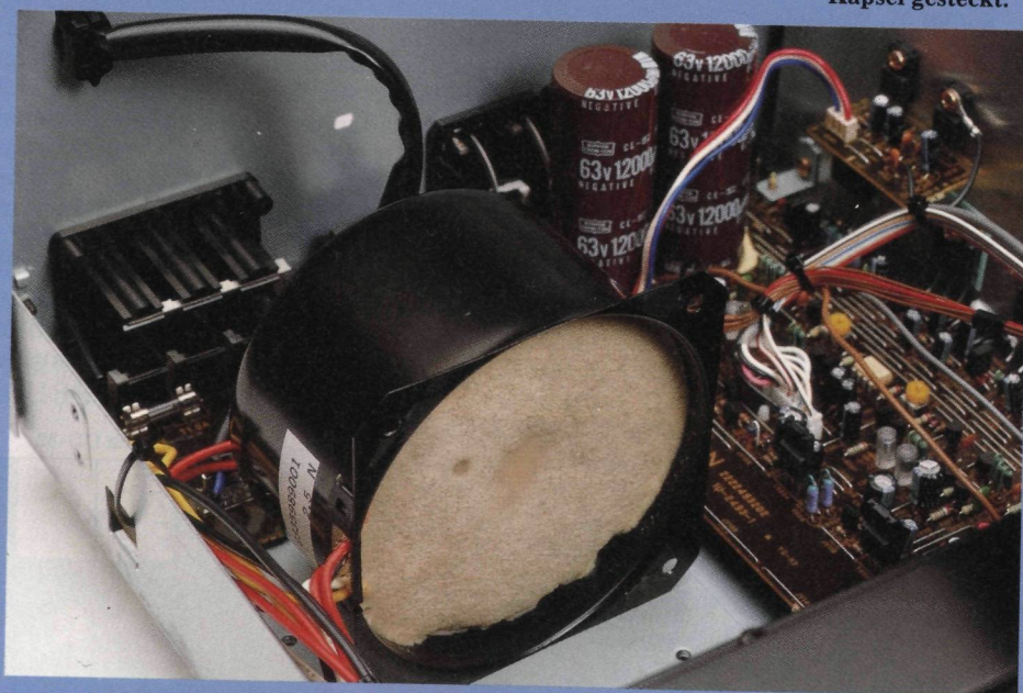
Damit der Trafo nicht brummt, hat Denon ihn in eine ausgeschäumte Kapsel gesteckt.
