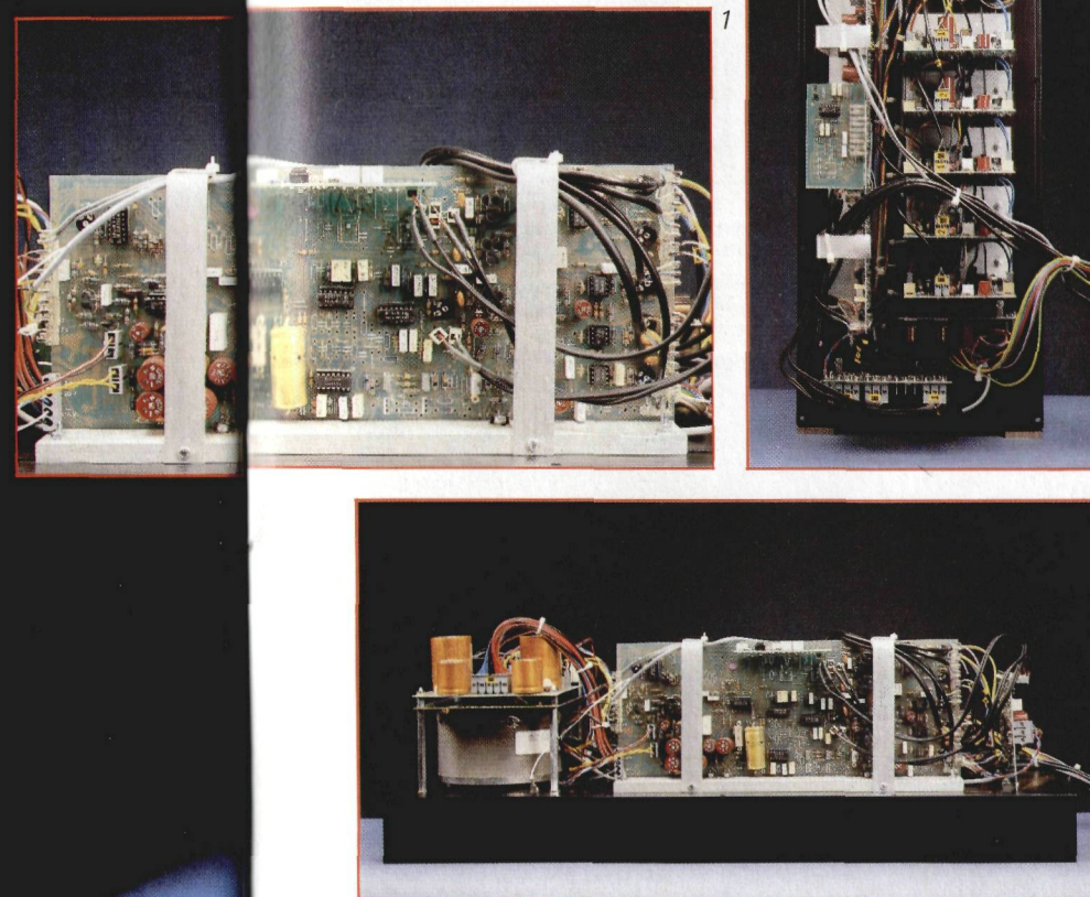
1) Die äußerst aufwendige Regelelektronik zwingt die Chassis zu optimalem Ein- und Ausschwingverhalten. – 2) Das Netzteil und je eine kräftige 130-Watt-Mosfet-Endstufe pro Chassis sind das Herz der BM14. – 3) Ein Ringkerntransformator versorgt alle fünf Endstufen gemeinsam mit Spannung
