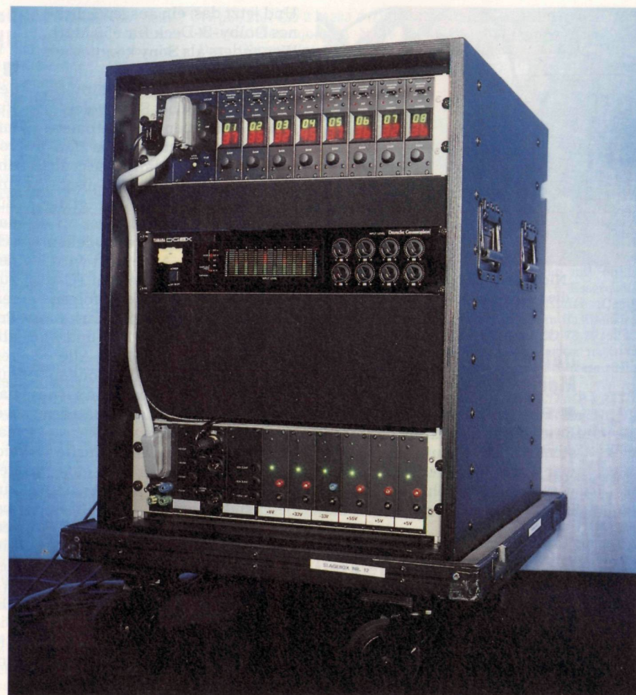
Die Stagebox mit Analog/Digital-Wandler und Vorverstärker. Die einzelnen Bauteile des Vorverstärkers sind hand- und ohrverlesen, die Schaltung des Gerätes ist eine Eigenentwicklung des DG Recording Centres.
