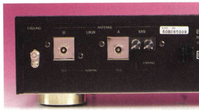
Tuner PT-3890: Ein Empfänger mit allen Schikanen. Die zweite Eingangsbuchse ist fürs Breitbandkabel gedacht. Es können aber auch zwei unterschiedlich ausgerichtete Antennen angeschlossen und an der Frontplatte gewählt werden.
