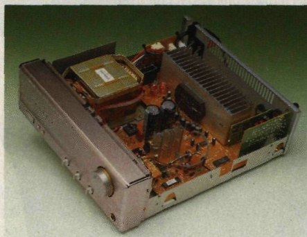
Das zentrale Netzteil des Denon-Verstärkers versorgt alle Komponenten mit der nötigen Spannung.
