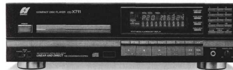
CD-Player CD-X711, L.D.C.S. Linear and Direct D/A-Wandler-System mit 2 Twin Balanced D/A-Wandlern, koaxialer und optischer Digitalausgang, symmetrischer Cannon-Type-Ausgang, Dreifach-Chassis mit Linearmotor, 9 unabhängige Hotstells, Balanced Servo-System, Random-Play, Music Scan, Compu-Edit, Fernbedienung.
