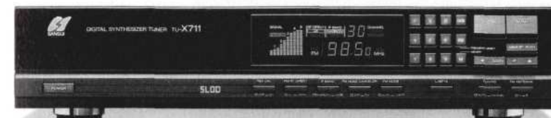
SLDD Quarz-PLL Synthesizer Tuner TU-X711, UKW, MW, superlinearer Digitaldecoder, superlineare Eingangsstufe, superlineare ZF-Stufe mit Bandbreitenumschaltung, Frequenzdirekteingabe, 30 Senderspeicher, HF-Betriebsartenumschaltung (Local/DX), 2 Antennen-Eingänge.
