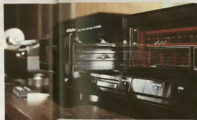
Der DAT-Recorder mit herausgenommenem Laufwerk. Deutlich ist die Rotations-Kopftrommel zu erkennen. Der Durchmesser beträgt drei Zentimeter
