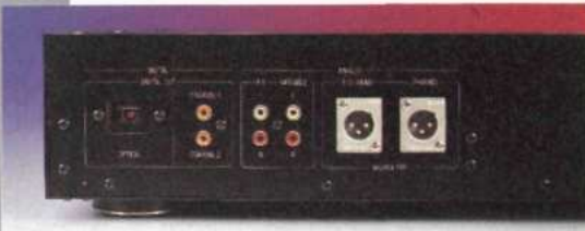
Denon DCD-3300 D: Neben analogen Anschlüssen in symmetrischer und asymmetrischer Technik fehlen auch die digitalen Ausgänge für Koaxialkabel und Lichtleiter nicht
