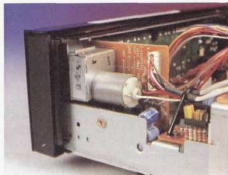
Der Shure D 6000 bietet bereits für 1350 Mark die Lautstärke-Fernbedienung per motorgetriebenem Potentiometer
