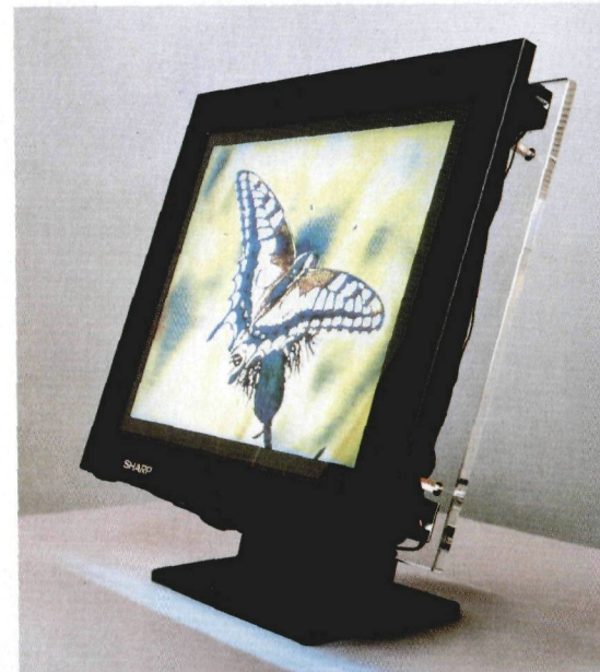
Ein weiterer Schritt zu den Fernsehern, die man an die Wand hängen kann: Sharps 27 Millimeter dünner Flüssigkristallbildschirm
