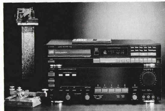
Luxmans erster CD-Player, der keinen D/A-Wandler besitzt: der LV-D113 D. Darunter der digitale Vollverstärker LV-113
