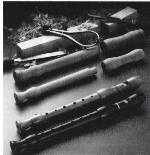
Blockflöten-Modell „Student“ der Firma Mollenhauer vom „Rohling“ bis zum fertigen Instrument
