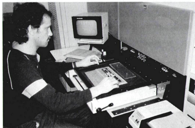
Mit Hilfe eines Testcomputers werden die Schaltungen (Prints) einzeln auf zuverlässige Funktion geprüft
