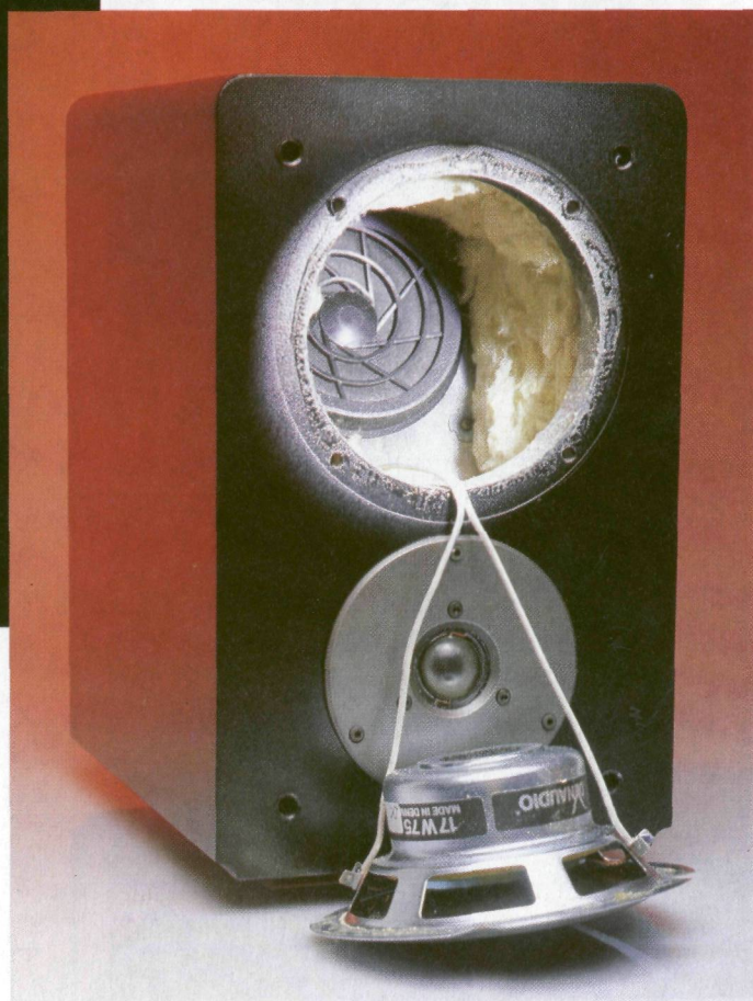
Compound 2 und 3 können unter Verwendung der auf Wunsch lieferbaren Lautsprecherfüße auch frei im Raum aufgestellt werden. Dynaudio-typisch ist die unkonventionelle Anordnung der Treiber: Tieftöner oben, Hochtöner unten auf der Schallwand. Hinter dem Variovent im Boxengehäuse sitzt der Sekundärtieftöner auf einer eigenen Schallwand
