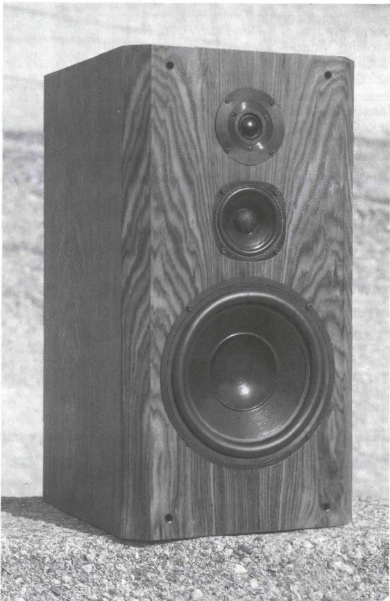
Der Tieftöner der ADL III ist durch Membranbeschichtung und konkave Schwingspulenabdeckung versteift; Kalottenhochtöner mit Ferro-Fluid-Dämpfung. Die drei Ausgleichsöffnungen auf dem Boxenrücken sind Teil einer unkonventionellen Baßreflexanordnung. Bei der Frequenzweiche (u.l.) legte T+A Wert auf schnelle Signalverarbeitung und minimale Phasenfehler; der Tieftöner arbeitet auf einem stabilen Gußkorb
