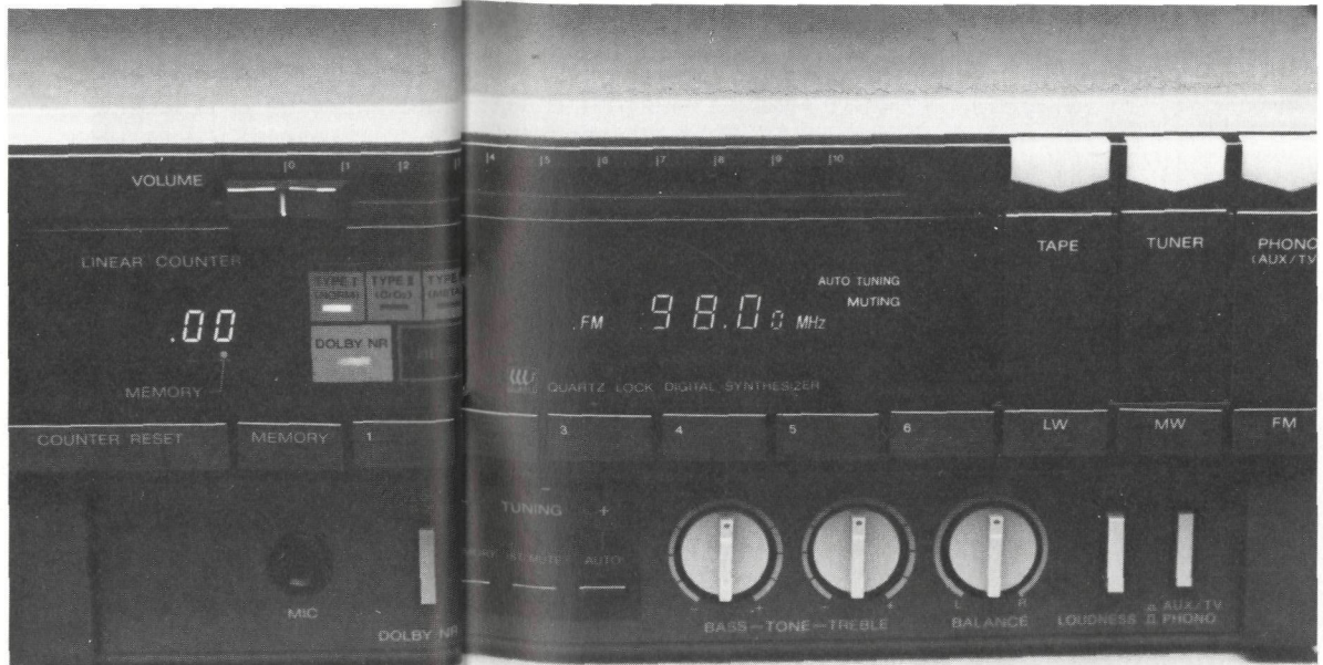
Das Bedienfeld des Sony XO-7 ist teilweise durch eine Klappe verdeckt. Bandsorteneinstellung erfolgt automatisch
