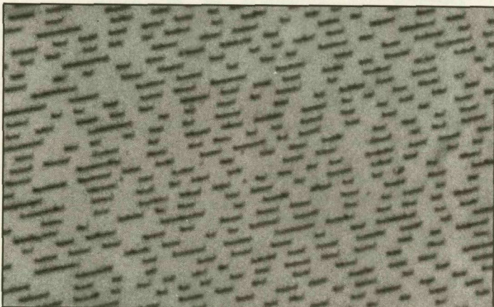
Die Mikroskop-Fotografie einer Sony PCM-Disc zeigt deutlich das Strichraster, in dem die Serien von „Nullen“ und „Einsen“ aufgelöst sind.
