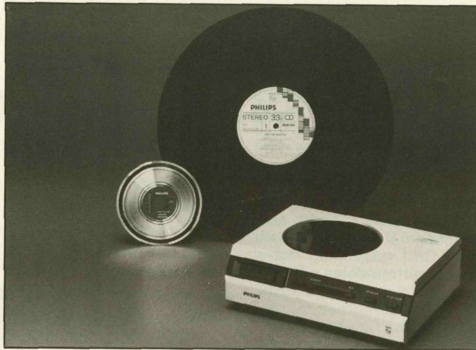
Philips' Prototyp des Laser-abtastenden Compact-Disc Spielers. Im Hintergrund die Gegenüberstellung einer konventionellen (Analog-) Schallplatte mit dem wesentlich kleineren PCM-Tonträger. Diese „offensichtliche“ Platzeinsparung bei gleicher oder sogar größerer Speicherkapazität wird auch als Pluspunkt der digitalen Audio-Technologie genannt.
