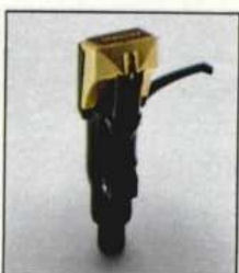
EPC-205 CMK 3 Stereo-Magnet-Tonabnehmer mit HPF-Kern und Boron-Nadelträger, incl. Systemträger, Übertragungsbereich 5-80.000 Hz.
