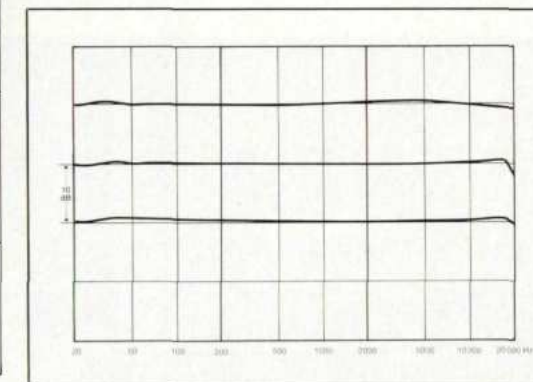
ASC 3000: Frequenzgänge ohne HighCom: Fe (oben), Cr (Mitte) und Metal (unten)
