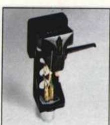
EPC-300 MC Neuer dynamischer Tonabnehmer mit zwei kernlosen Doppelringspulen. Nitriergehärteter Titan-Nadelträger. Ellipt. Diamant. Übertragungsbereich 10-50.000 Hz.
