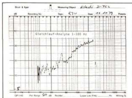
Analyse der Gleichlaufschwankungen beim Hitachi D-75 S. Die Zunahme der hochfrequenten Anteile ist zwar sehr deutlich, wird aber vom Ohr nicht in gleichem
