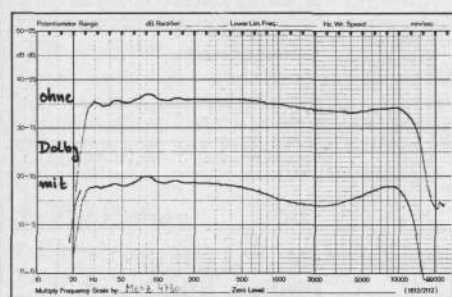
Gesamtfrequenzgänge des Cassettenteils Metz 4730 mit und ohne Dolby beim DIN-Band
