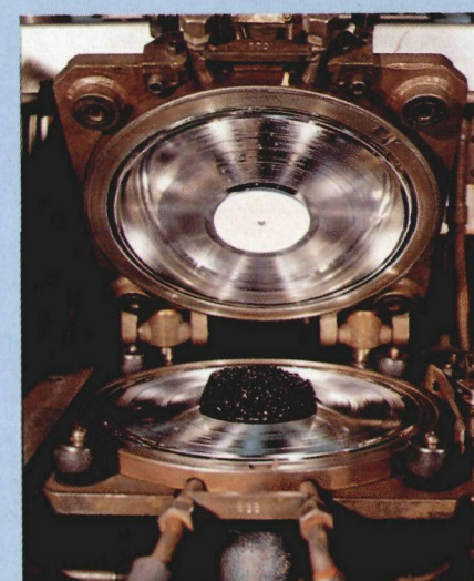
Langspielplattenpresse: Massekuchen und Etikett vor dem Preßvorgang
