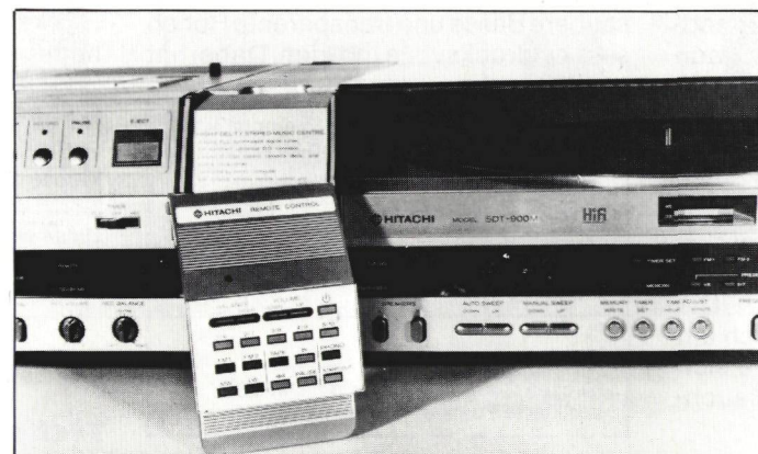
Ausschnitt der Frontseite mit abgenommener Fernbedienung
