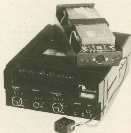
Das Nakamichi 350 mit Akku und Ladeelectronic. Dieses Stromversorgungsteil wird für Außenaufnahmen links in die Tragetasche eingebaut.
