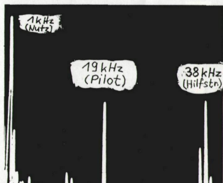
Nutzfrequenz 1 kHz, Pilot und Hilfsträger mit unerwünschten Seitenbändern beim „FG“
