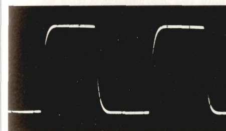
500 Hz-Rechteckimpuls an einer komplexen Lautsprecherlast beim Optonica SA-3131 H
