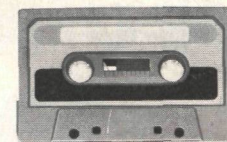
Das Band dieser Cassette hat eine Chromdioxid-Beschichtung (CrO 2 ). Tonfäden gehen oft verloren.
