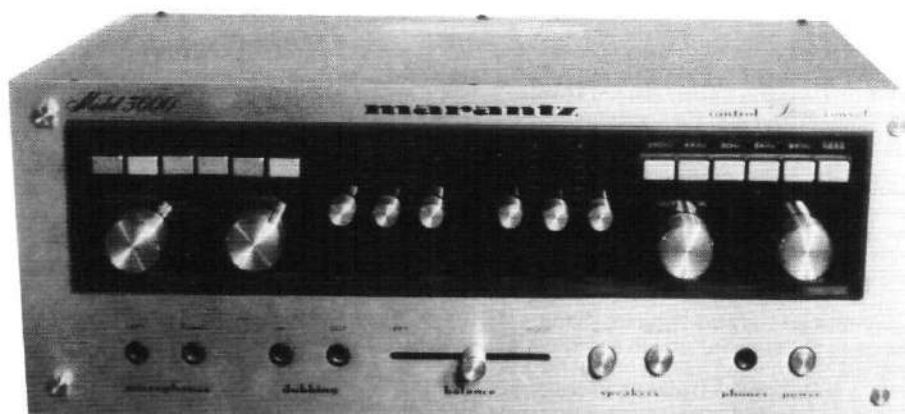
Der Vorverstärker Marantz 3600: In der Mitte sind die Schieberegler für drei Frequenzbereiche angeordnet (je drei Stück für links und rechts getrennt).
