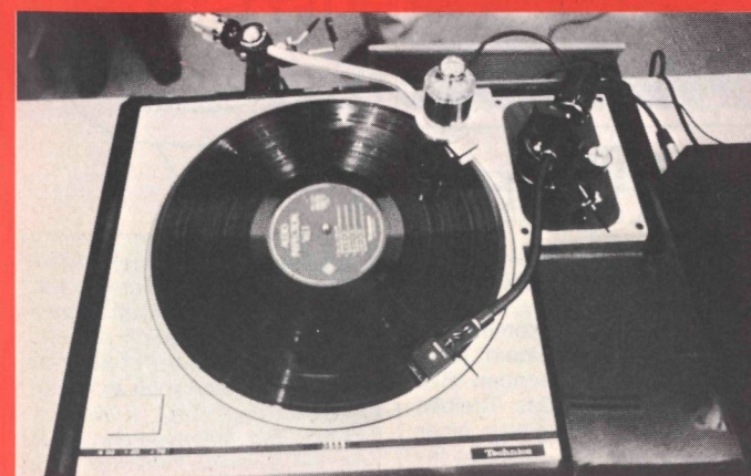
Im Test: Ein Zusatztonarm mit 1 kg Gewicht und Filzauflege vermag das Laufwerk SP-10 MK II von Technics nicht zu bremsen
