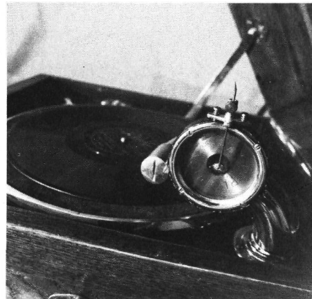
Die Schalldose in hochgeklapptem Zustand mit eingespannter Stahlnadel
