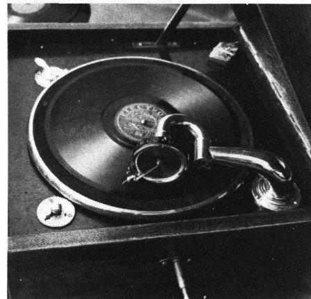
Spielbereiter Zustand mit eingerasteter Bremse
