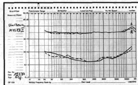
Frequenzgang des Tonabnehmers Shure M 75 ED Typ 2 eingebaut in den Tonarm des Strathearn SMA 2
