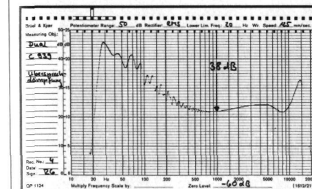
Übersprechen zwischen den beiden Stereospuren beim Dual C 939
