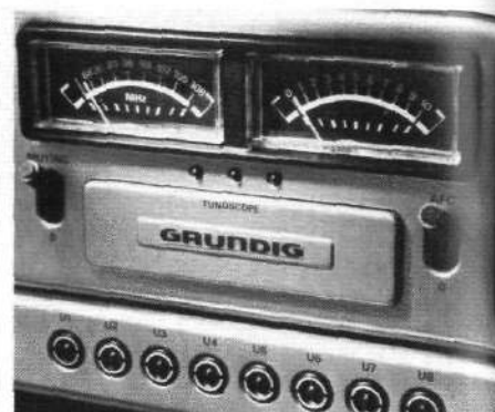
Mit der UKW-Abstimmhilfe „Tunoscope“ läßt sich bei den HiFi-Recordern 30 und 40 die Sendermitteneinstellung leicht bestimmen. Sie wird durch Leuchtdioden exakt signalisiert.
