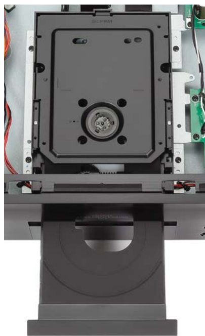
Das Denon-eigene Laufwerk ist solide, leise und zudem für CD, SACD und sogar DVD ausgelegt.
