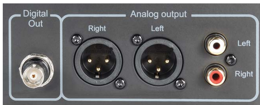
Das Anschlussfeld des Viking ist übersichtlich: Cinch und XLR als Analogausgänge und eine 75-Ohm-BNC-Buchse als Digitalausgang.
