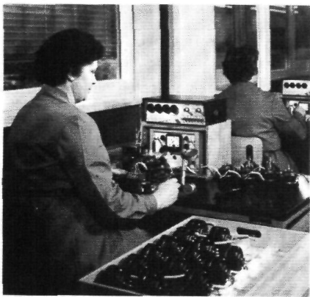
Der fertige Motor wird auf Funktion und richtige Umdrehungszahl geprüft.
