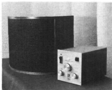
Der Processor des KM-Systems und eine der beiden relativ kleinen (36 cm breiten, 27 cm hohen) Wandboxen mit stark gewölbter Frontfläche. Rechts: Frequenzgangkurve in unserem Abhörraum, wie üblich aufgenommen von den Positionen der fünf Jurorenplätze
