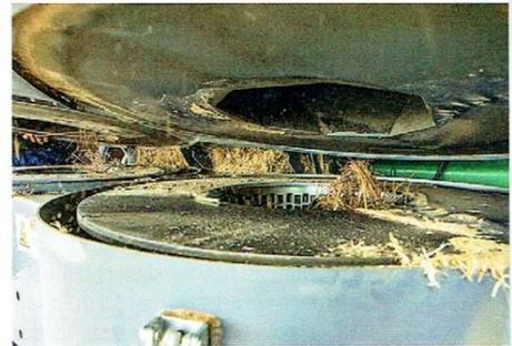
Der Seed Terminator arbeitet mit zwei rotierenden Hammermühlen.
