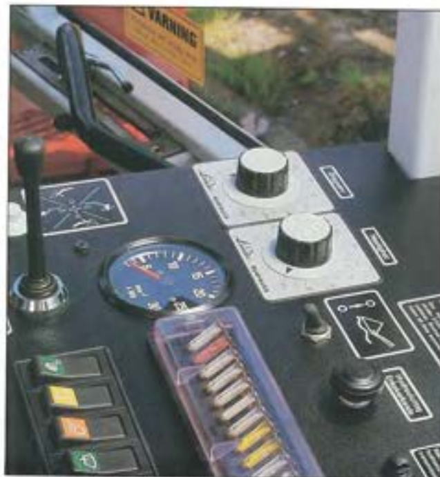
Vridreglage för inställning av dragvarv och hastighet.
