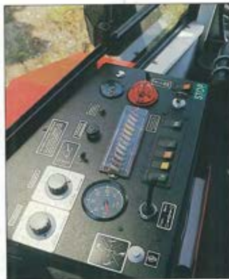
De båda välutrustade manöverpanelerna är bl.a. försedda med var sin växelväljare för fram och back samt centrallarm för viktigare funktioner.
