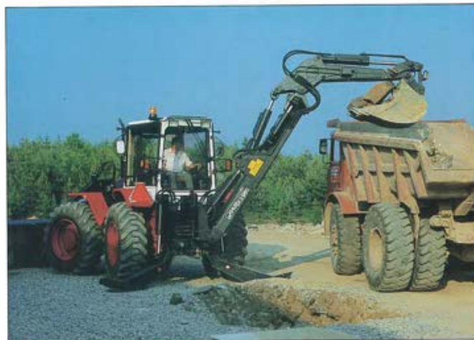
Grävaggregatet har hög lasthöjd.
