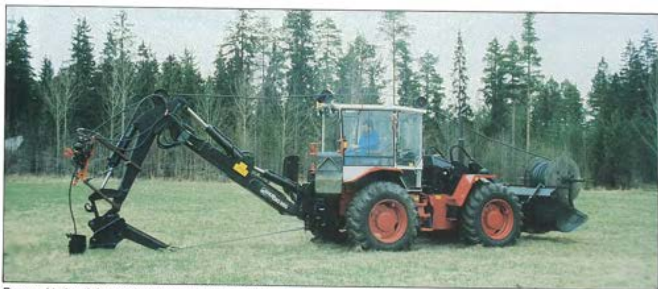
Den exakta hastighetsregleringen gör Huddig 960 mycket lämplig som kabelplöjningsmaskin.
