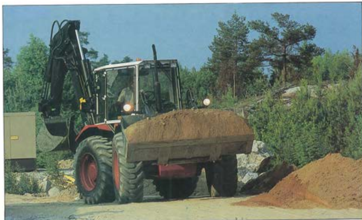
54° vid praktiskt bäriläge ger litet materialspill.
