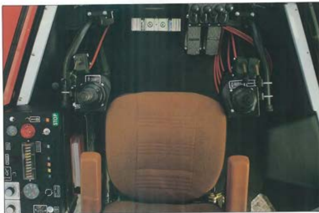
Ergonomiskt riktigt placerade reglage (spakstället vid rutan är extrautrustning.)
