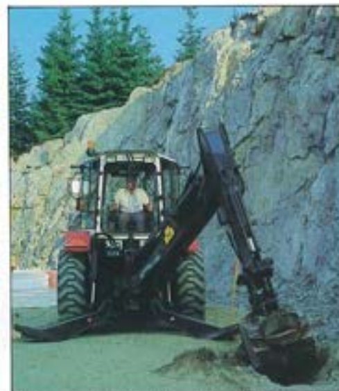
Grävvarmen är steglöst vridbar i förhållande till bommen.
