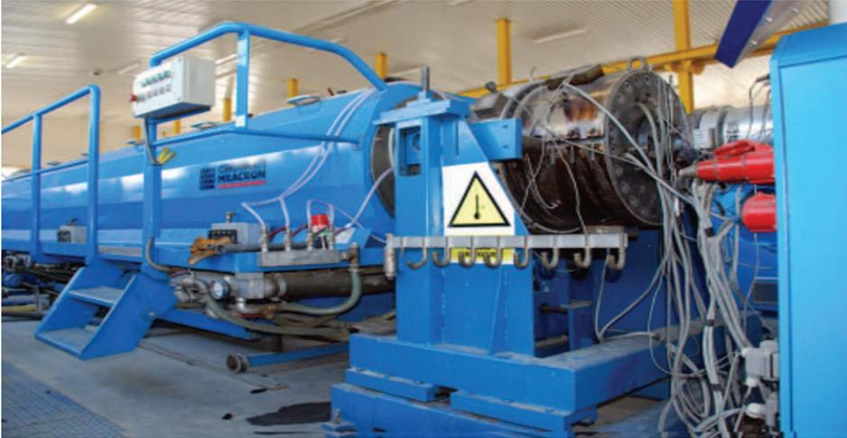
Aktuell wird der Einsatz von Diffusionsbarrieren in Kunststoffmantelrohren bei den Betreibern von Wärmeverteilnetzen kontrovers diskutiert. Diffusionsbarrieren aus Aluminiumfolie sind seit Jahren bei kontinuierlich hergestellten Rohren bekannt. Diese Folien werden technologisch bei dem Axialkontiverfahren benötigt.
