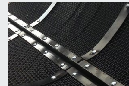
Siebgitter Öffnungen 6 bis 40 mm
